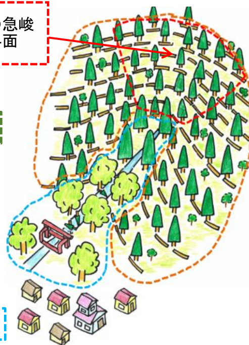
土留工の設置により表面侵食防止機能が向上
