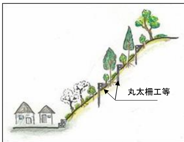
人家裏山の斜面で簡易防災施設を設置
