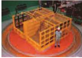
地震に強い斜面工法ビデオ説明 (振動台模型での実験状況)
