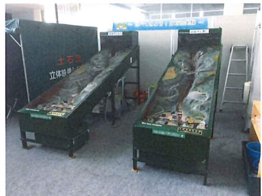
③土石流模型実験装置
